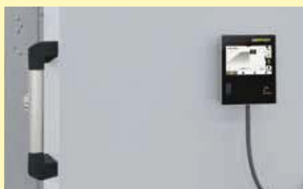
Controlleren er anbragt i ovndøren og kan tages af for komfortabel betjening
