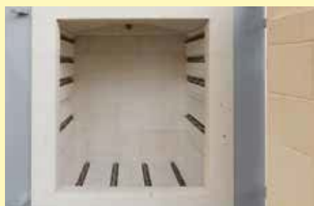
Opvarmning i tre sider med varmelegemer beskyttet i riller
